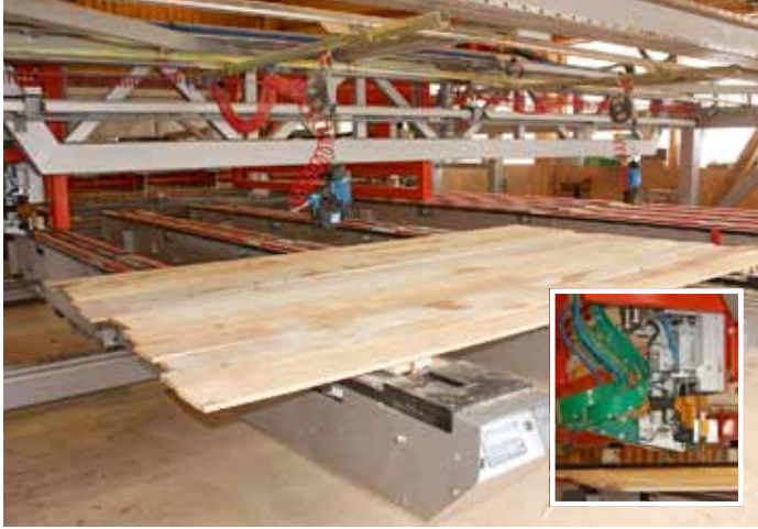
Die Brettlagen werden für die Kistenelemente vorbereitet und mittels Nagelgeräten automatisch fixiert
