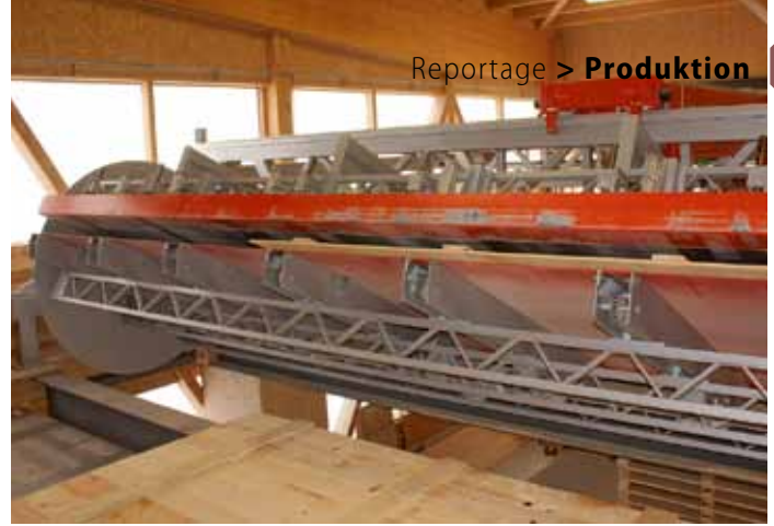
Die fertigen Elemente werden Platz sparend um die Mittelachse gedreht und abgestapelt
