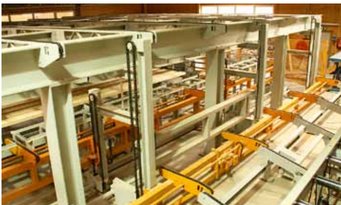
Mehretagenlager von Holmag verbindet die beiden Keilzinkenanlagen miteinander und dient als Zwischenpuffer
