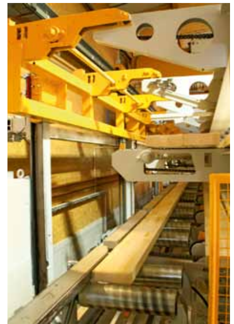
Satellitenförderer bringt die Lamellen aus dem Lager zur Finalhobelmaschine
