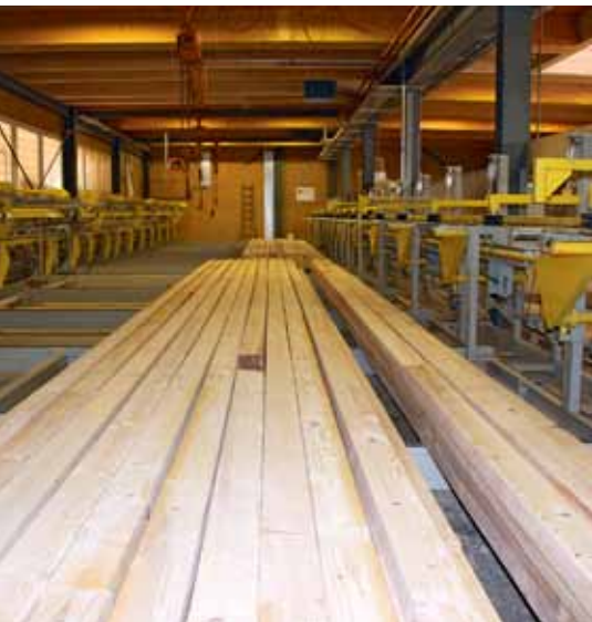
Großzügig dimensioniertes Lager für die keilgezinkten Lamellen
