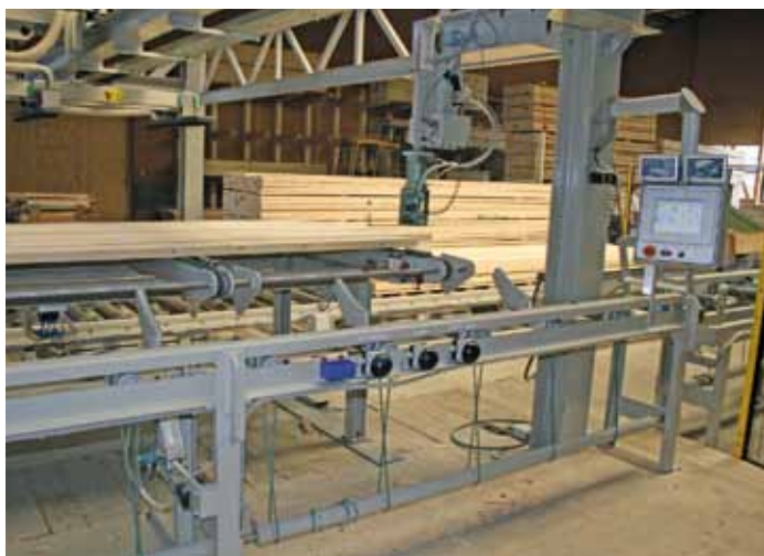
Bei der Anlagen-Beschickung ist ein Mitarbeiter beschäftigt, hier sind auch die Monitore für die Keilzink-Überwachung installiert
