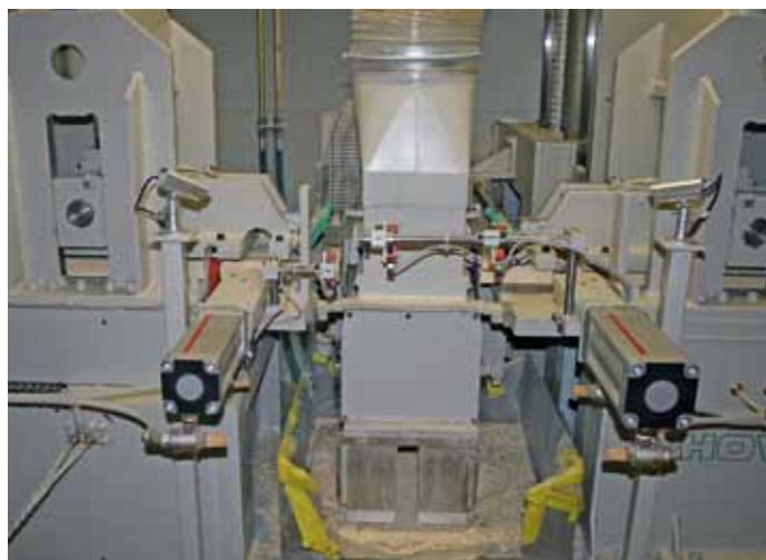
Flyback Keilzinkenautomat von Howial wurde eigens für Stuber & Cie entwickelt
