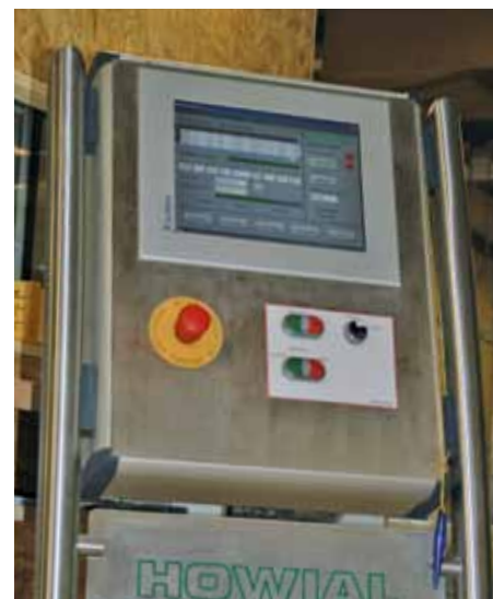
Kombiniertes Bedien- und Leitsystem steuert den gesamten Produktionsablauf
